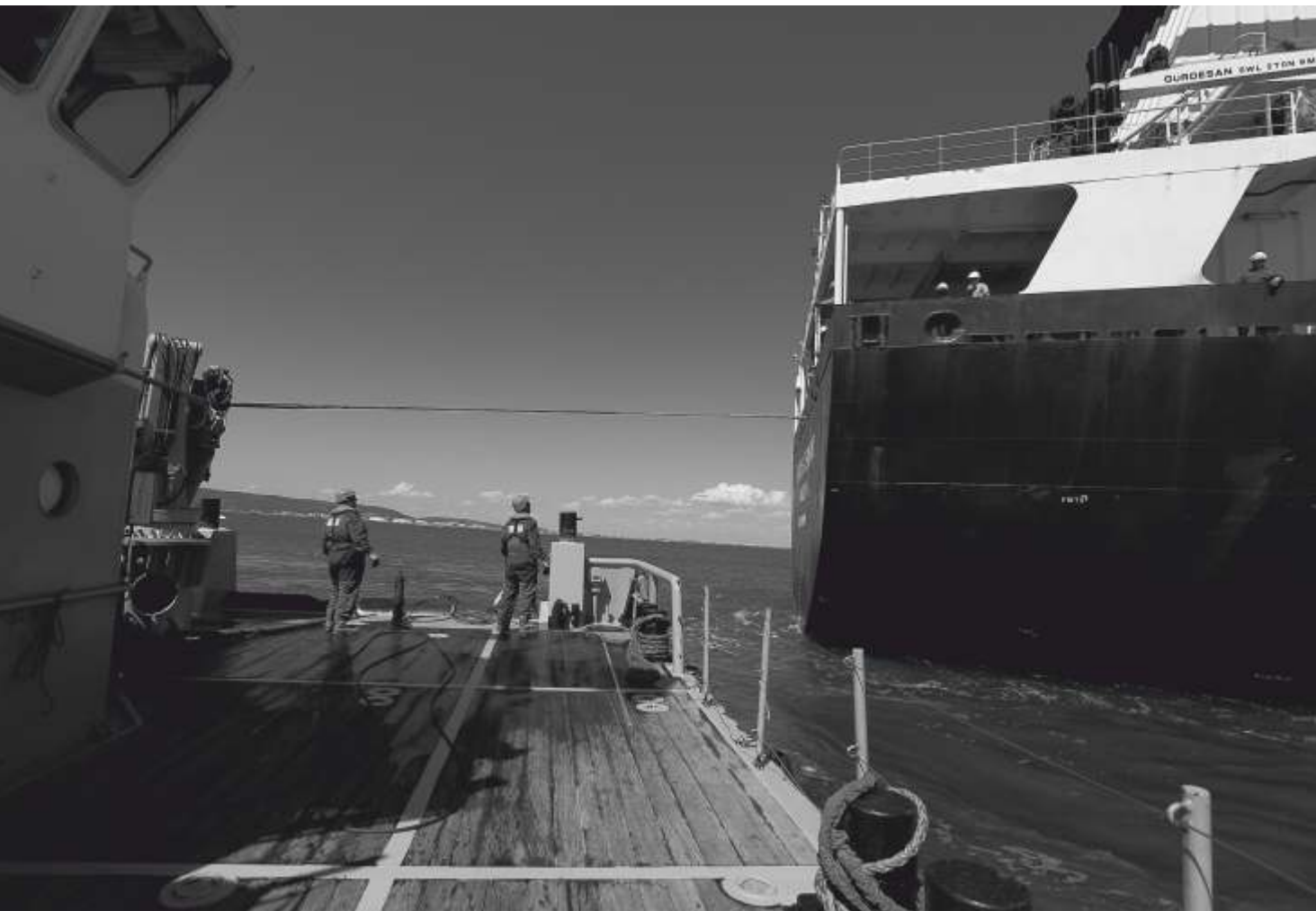
La deuxième amarre est tendue. Le remorqueur va tirer le pétrolier et le maintenir en position pour permettre à Jifmar de positionner les 2 autres amarres. 5 à la poupe, 2 à la proue en plus des 2 ancres, on ne badine pas avec la sécurité.
