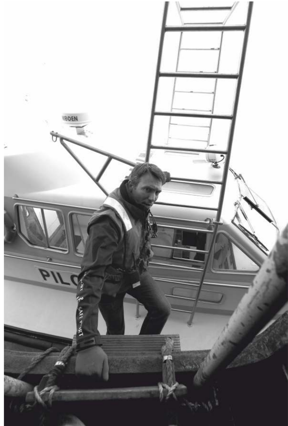
L'échelle de pilote est descendue, c'est la passerelle d'accès à bord du pilote. La porte du ferry semble minuscule...
