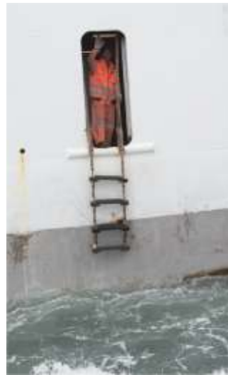
L'échelle de pilote est descendue, c'est la passerelle d'accès à bord du pilote. La porte du ferry semble minuscule...
